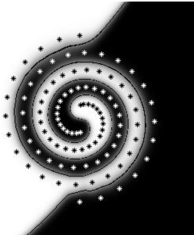
Abbildung 4.9: Separation zweier Spiralen. Die 100 Sterne markieren das Trainingsset: Weiße Sterne haben den Wert 0, schwarze 1. Die Linie besteht aus den Punkten, an denen das GRNN den Wert 0.5 liefert, also der Grenze zwischen den Spiralen.
